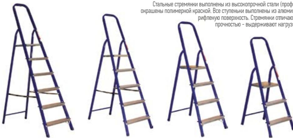
Стальные стремянки выполнены из высокопрочной стали (профиль 30x20) и окрашены полимерной краской. Все ступеньки выполнены из алюминия и имеют рифленую поверхность. Стремянки отличаются высокой прочностью - выдерживают нагрузку до 150 кг.
