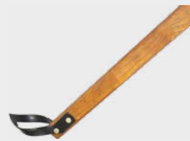
Плоскорез "Стриж" малый Судогодский. Длина режущей части 80 мм. Глубина обработки почвы до 7 см. Черенок 1300x38x18 мм
