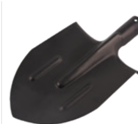
ЛОПАТА ШТЫКОВАЯ ЛКО Б/Ч Материал: сталь 3, толщина 1,5 мм Покраска: порошковая Сварная тулейка D=36 мм
