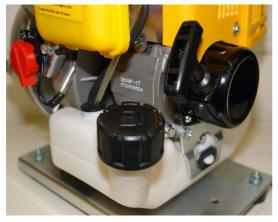
Откручивайте черную крышку бензобака. Для этого вращаете ее ПРОТИВ часовой стрелки.
