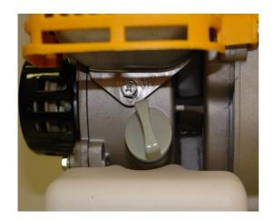
Откручивайте серую крышку картера. Для этого вращаете ее ПРОТИВ часовой стрелки.
