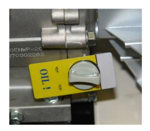
Откручивайте серую крышку картера. Для этого вращаете ее ПРОТИВ часовой стрелки.
