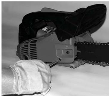
начиная с верха. Кромки режущих звеньев на верхней кромке шины должны быть направлены к звездочке.
