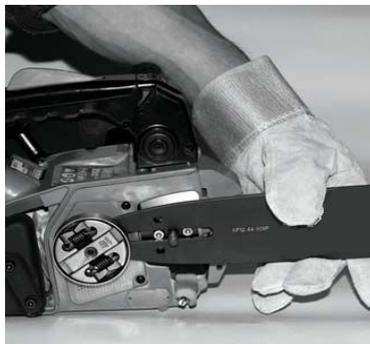
2. Открутите гайку на боковом щитке и снимите крышку с корпуса пилы.
