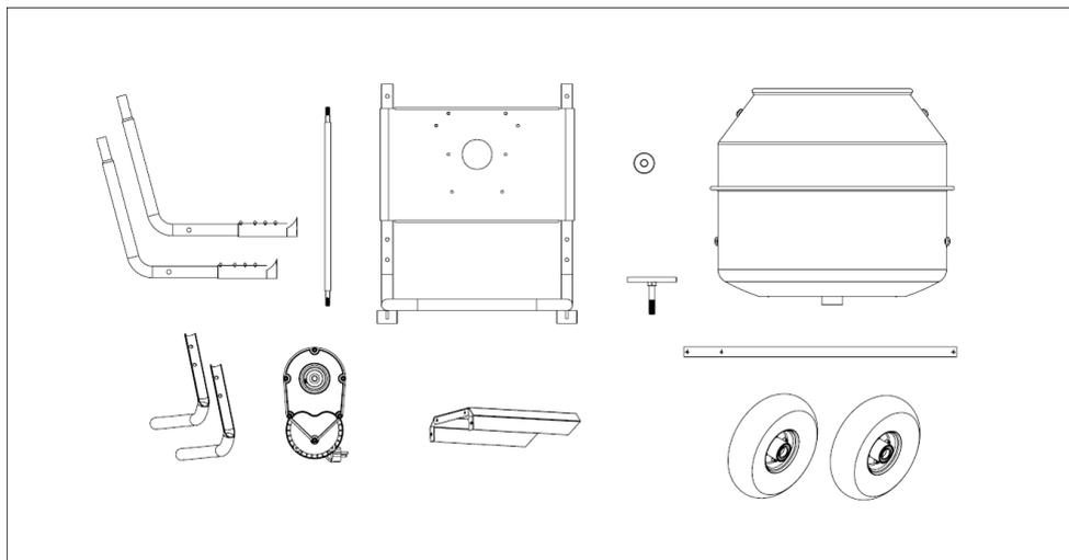
Наденьте колеса на ось, закрепив их при этом с помощью шайб и шпилек, как показано на рисунке.
